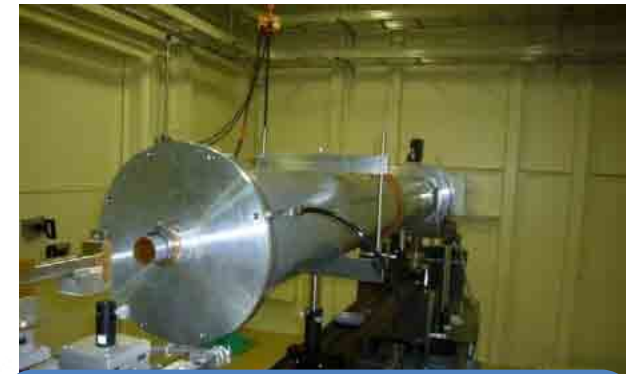
小角X線散乱 (SAXS) カメラ長:2~3m
