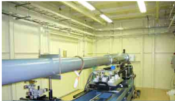
極小角X線散乱 (USAXS) カメラ長:40m
