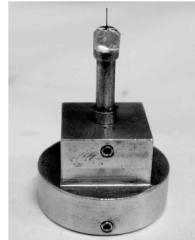
図4 結晶を取り付けたゴニオメータヘッド
