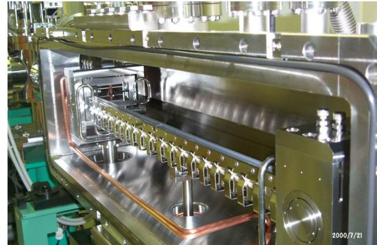
図 19. 側面水冷偏向電磁石ビームライン白色用ミラー
