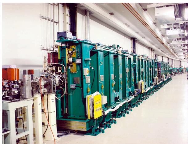
図5 BL19XUの27 mの長尺アンジュレータ蓄積リングの直線部に設置した状態で全長27m、磁石長は25m、周期長が32mm、周期数は780、最大磁場はギャップ12mmで0.57T。
