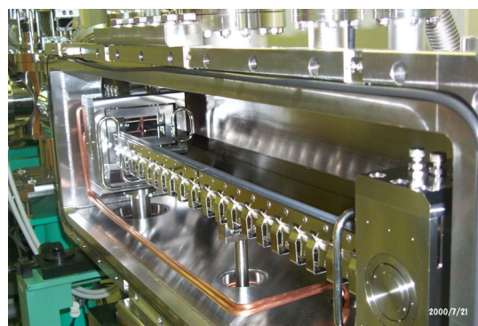
図 19. 偏向電磁石ビームライン白色用ミラー および保持機構 (1 m 長用, 水冷およびベント機構付)
