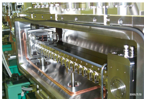
図 5. 偏向電磁石ビームライン白色用ミラー および保持機構 (1 m 長用, 水冷およびベント機構付)
