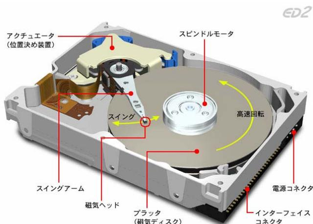
図1 ハードディスクの構造 [2]
