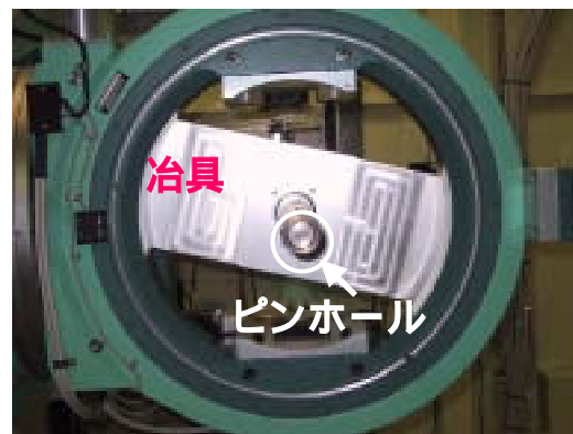
図6 治具をクレードルに設置した様子(上流側から見た様子)
