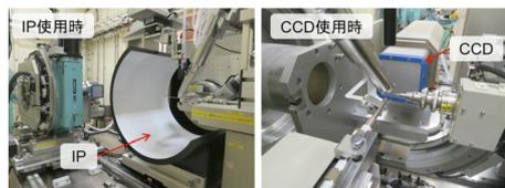
現在使用している大型湾曲IPカメラに緩衝せずデータの読み取り時間の短く、且つユーザー自身が切り替え可能な検出器としてCCD検出器を導入した。本検出器の導入により、超分子結晶のような不安定かつ比較的大きい結晶格子を有する単結晶試料の測定が可能になっただけでなく、これまでピークタイムの制約により非現実的であった構造解析を目的としたポンププローブ法による時間分解実験の実施が期待される。
