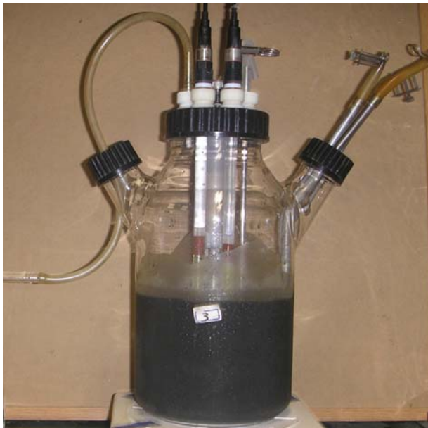
固形物濃度が2%程度の下水汚泥含有されるリンの抽出実験
