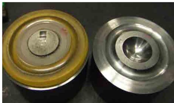
図1. トロイダルセルとアンビル
