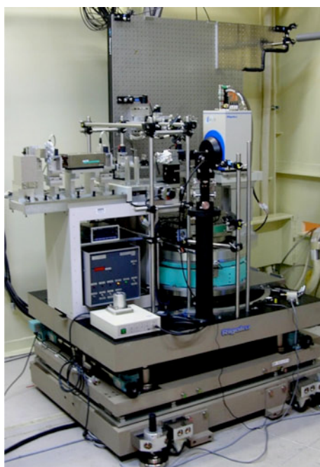
図1 BL40XU ピンポイント計測精密回折計. (参考文献 : N. Yasuda, et al., J. Synchrotron Rad., 2009 , 16 , 352-357.)
