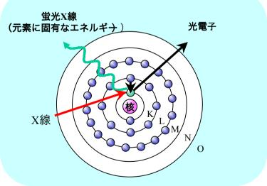
これが蛍光X線です。このエネルギーは元素に固有であるため、エネルギーを分析すると元素の種類を知ることができます。 X線により原子の内殻軌道の電子が外にたたき出されると、外の軌道の電子が内殻に遷移します。この時のエネルギー準位の差に等しいエネルギーの光X線)が放射されます。
