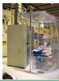
試料準備は実験ハッチのすぐ外に設置された2重構造のクリーンブースの中で行う
