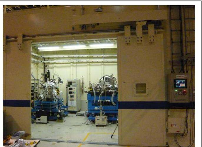
図 2 BL46XU に新設された実験ハッチ内に設置された硬 X 線光電子分光装置。写真左方向が上流 (光源側)。
