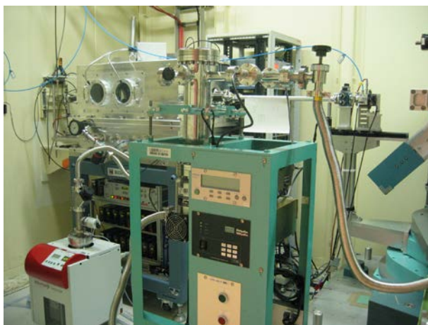
図 BL19LXU での偏光回折実験セットアップ。(左写真)チェンバー内に収められた移相子によりX線の偏光状態を制御し、(右写真)多軸回折計によって任意の結晶方位での回折実験を実施することが可能。試料冷凍機と偏光解析装置の使用も可能。
