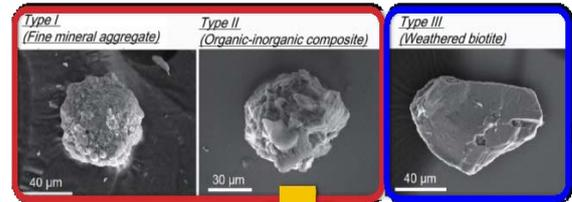
図1. セシウムが濃縮している土壌微粒子のSEM画像
