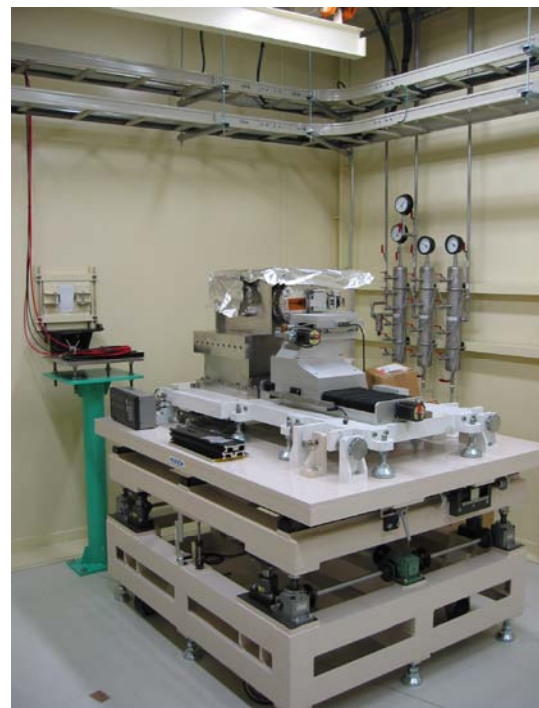
Fig.6. Grazing incidence spectro-reflectometer
