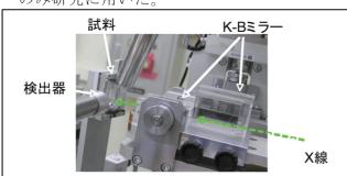
Fig. 1 試料ホルダー周辺: 試料、検出器、K-Bミラー、X線の方向
