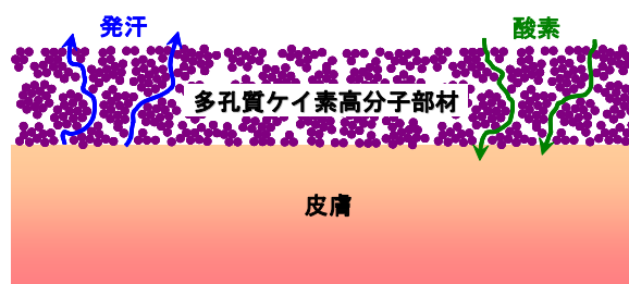
Fig.1. ケイ素系高分子を用いた「低侵襲性部材」の概念図。「第2の皮膚」としての機能を果たすよう、酸素/水蒸気の供給/放出のための多孔構造を有している。
