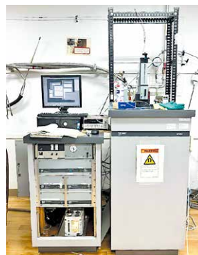
図3 気体を通しながら磁気測定ができる装置
