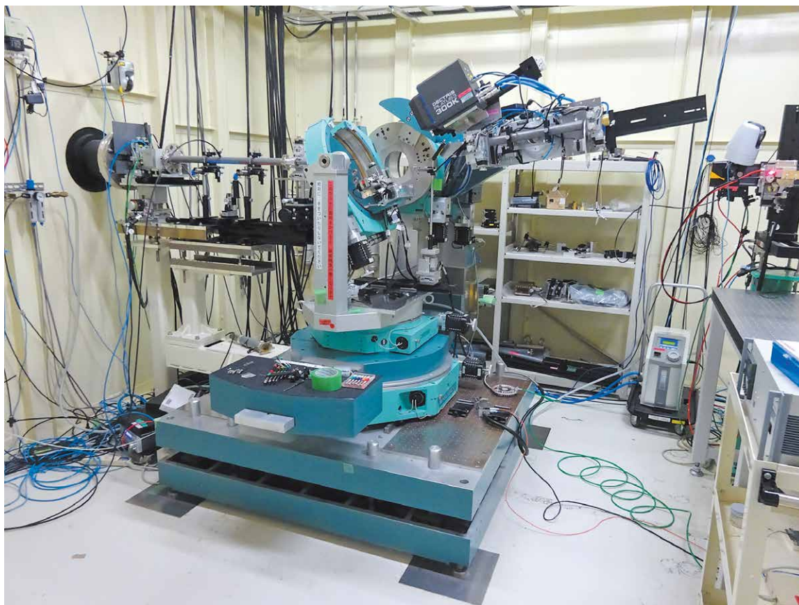
BL19B2に設置された多目的6軸回折計の全景
