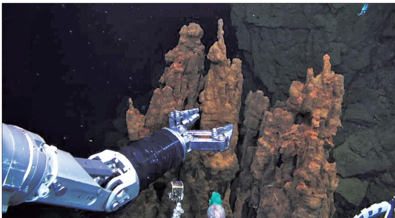
図1 無人潜水艇のアームでチムニーを採取している様子
