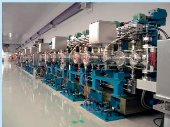
図3. 真空封止型アンジュレータ。銀色の真空パイプ（真ん中の円筒）の中に磁石列が入っています。
