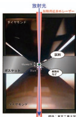
図1. 対向したダイヤモンドアンビル。この中央部分に試料を金属ガスケットで封入して、超高压を発生させることができる。
