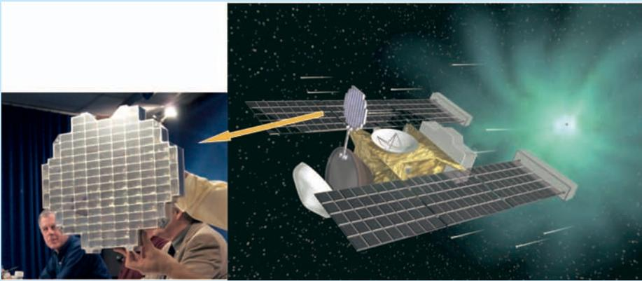
図1. スターダスト計画の探査機「スターダスト」。ウィルト第2彗星(81P/Wild2)の背後に回りこみ、まき散らされたダストを採取した(右)。ダスト採取装置は、密度が5~30グラム/リットル(水の100分の1程度)という世界一軽い固体であるエアロジェルのセルが並べられたもの(左)。(いずれもNASA提供)
