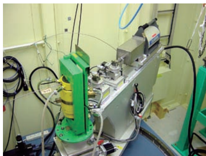
図2. 左はSPring-8のビームラインBL28B2に取り付けられた高温・高圧用実験装置（黄色の装置）。右は水銀を入れるサファイヤ製容器。
