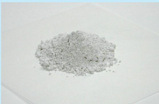
図1. C12A7 (酸化カルシウム・酸化アルミニウム化合物、 $12\text{CaO} \cdot 7\text{Al}_2\text{O}_3$ ) の粉末。
