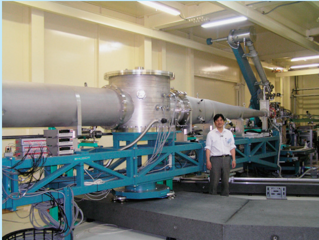
図2. 全長20mにも及ぶ巨大なX線非弾性散乱スペクトロメーター。世界で4つしかない同種の装置の中で、最も高いエネルギー分解能と最も強いX線強度を誇る。10mのアームは、空気でステージの上に浮かせて最大50°ほど向きを変えることができる。
