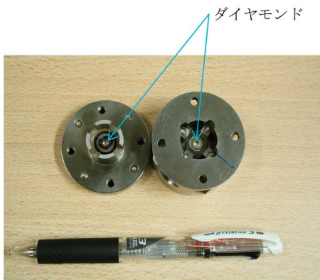
図2. てのひらに乗るほどの大きさの高压装置・ダイヤモンドアンビルセル(写真左)。その中心部(写真右)には、ブリリアントカットされ先端部を少し切り落としたダイヤモンドが装着されており、先端部に試料を挟んで2つの容器を合わせてネジを締めると極めて高い圧力がかかる。
