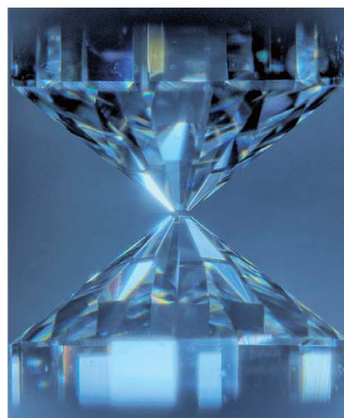
図2. てのひらに乗るほどの大きさの高压装置・ダイヤモンドアンビルセル(写真左)。その中心部(写真右)には、ブリリアントカットされ先端部を少し切り落としたダイヤモンドが装着されており、先端部に試料を挟んで2つの容器を合わせてネジを締めると極めて高い圧力がかかる。
