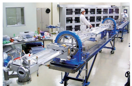
図2 クリーンルーム内で真空チャンバーに真空ポンプを組み込む
