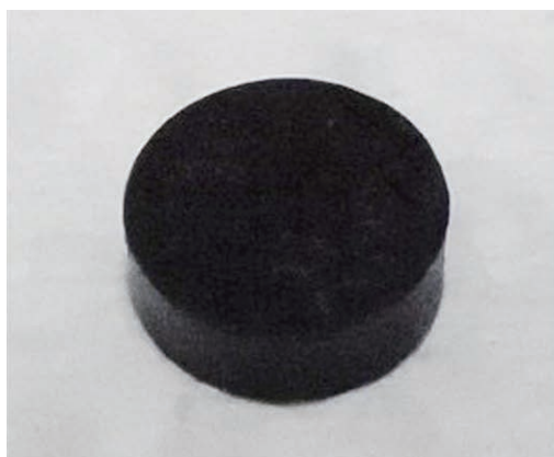
図3 左は、エポキシ樹脂にBNFOを分散させた複合材料（コンポジット）の写真。右は、エポキシ樹脂（黒）とBNFO（青）、これらの複合材料（赤）の温度変化による長さの変化を表わしたグラフ。300～330K（27～57℃）の範囲でゼロ熱膨張が実現していることがわかる。
