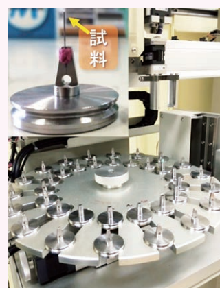
図2 自動試料交換口ボット 一度に36試料のマウントが可能。
