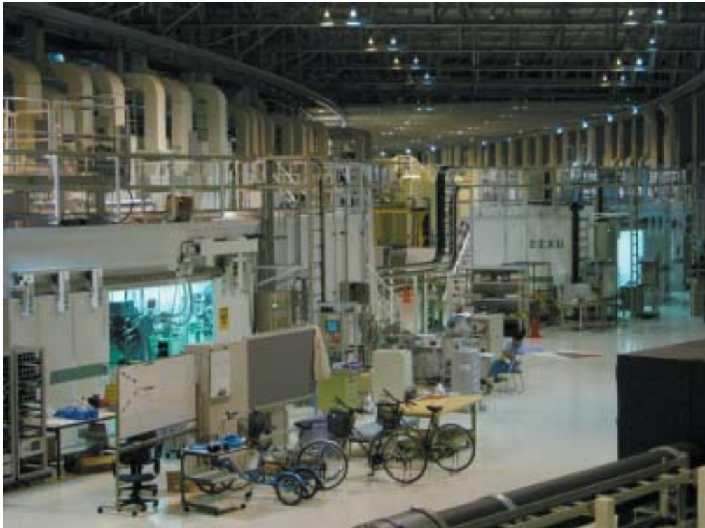
図1 量子構造物性ビームライン BL22XU 蓄積リング棟実験ホール内の全景。手前より光学ハッチ、実験ハッチ1、実験ハッチ2を見る。光学ハッチと実験ハッチ1の間は分離しており、また最後部の実験ハッチ3はRI棟内にある。
