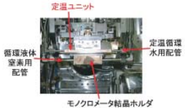
Figure 2 : モノクロメータ結晶台の変更後。第2ステージ部分の拡大図。
