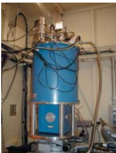
図4 X線磁気吸収およびX線磁気回折実験に用いられる He 再凝縮装置付き10 T 超伝導磁石。
