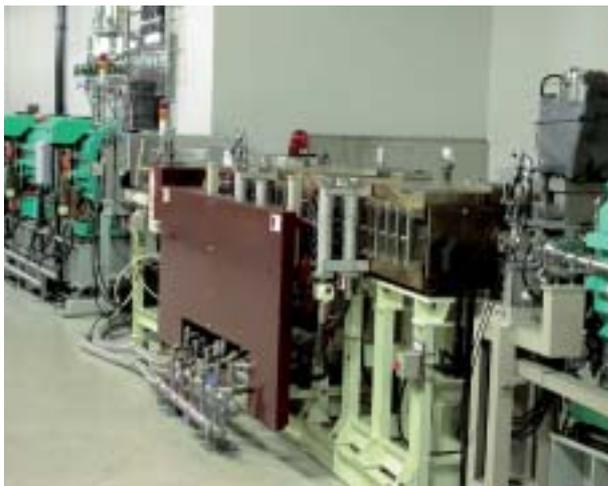
蓄積リング入射部に導入された新しいセプトム電磁石。加速器の高機能運転などで問題となる蓄積リングへのもれ磁場対策がなされている。
