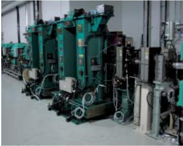
BL25SU ツインヘリカルアンジュレータと円偏光方向スイッチングのためのキッカー電磁石。
