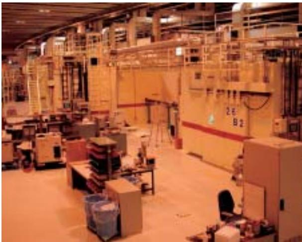
ハイスループットデータ収集を目的にSPring-8に設置された理研構造ゲノムビームライン（BL26B1およびBL26B2）。このビームラインでは結晶のマウント、アライメントの自動化を行ない、収集した回折イメージをデータベースとして一括統合管理が可能となっており、測定の大量、高速化に対応できる。
