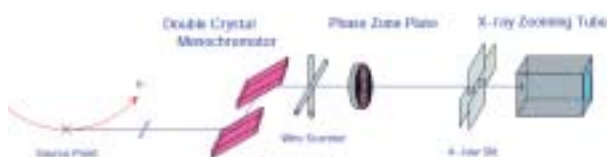
図8 位相型ゾーンプレートを用いたX線ビームプロファイルモニター
