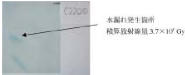
図16 ゴムホース部の放射線量の測定
