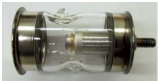
図12 カートリッジ式カソードの試作品 ペローズ先端に直径7.2mmのカソードがあり、 リング状のRFコンタクトが付いている。
