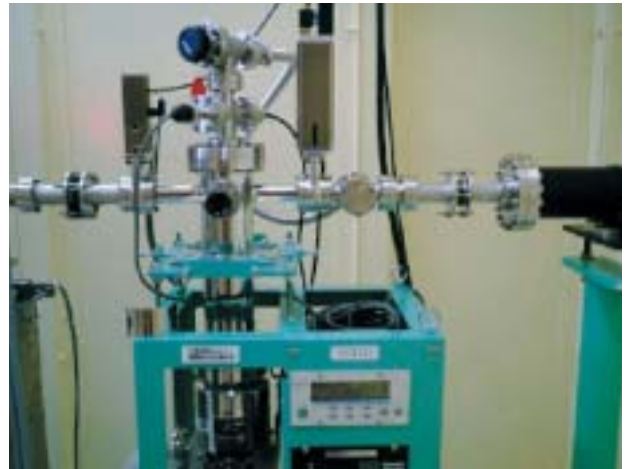
図4 光学ハッチ内分光器下流に組み込まれた高速遮断バルブ
