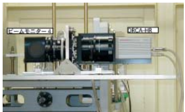
図1 実験ハッチ3に配置されている、可視光変換型の二次元検出器。「ビームモニター4」と「ORCA-HR」により構成されている。
