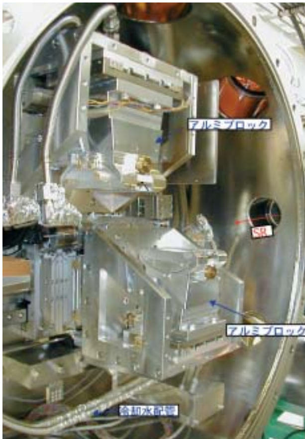
図3 分光器内部。Xx1・1・Xx2・2の4つの軸が取り外され、アルミブロックに置き換わっている。冷却水配管用のフレキシブルチューブの中には、ウレタンホースが通っている。
