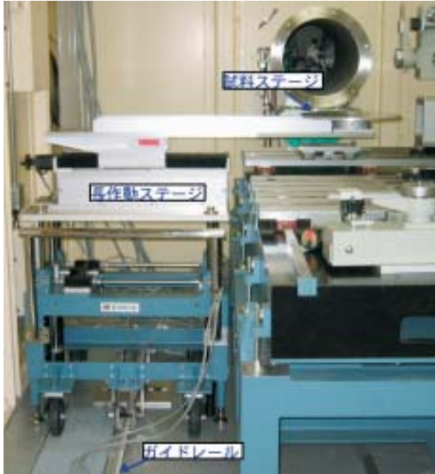
図2 実験ハッチ3に配置された長作動距離ステージ。試料ステージは既設の定盤を回避するような格好になっている。ガイドレールは、ハッチ内ほぼ全域をカバーできるように敷かれている。
