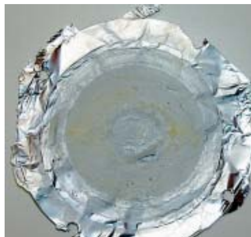
図1 大気中で白色放射光を3日間照射した結果、酸化したアルミ箔。
