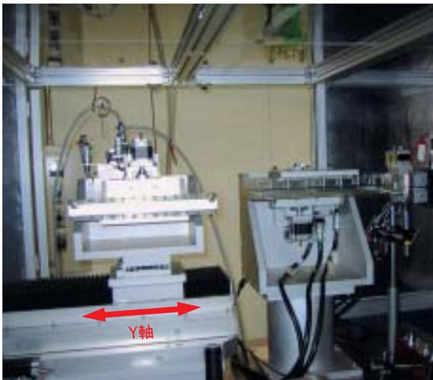
図1 鉛ハッチ内の高調波除去ミラーシステム(エネルギーを変更した場合にも定位置出射が可能となるようにY軸が移動可能)
