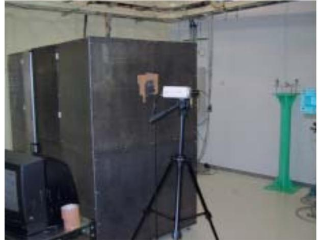
図2 実験ハッチ内に設置された鉛ハッチの様子(図1に示したミラーシステム全体がこの中で収められている)
