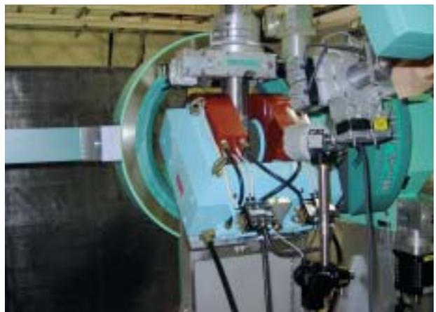
図3 6軸回折計のクレードルに設置された電磁石アタッチメント
