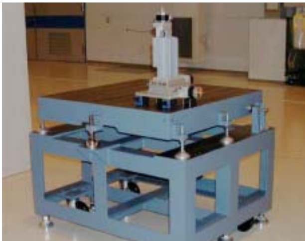
図1 汎用光学定盤とXYZステージ
