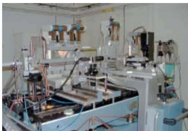
図3 走査型X線顕微鏡光学系
