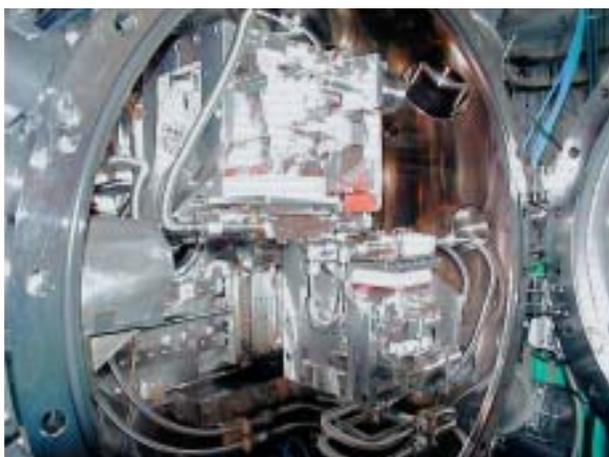
図2 分光器内部 Tx軸、Ty軸、 軸、x軸の撤去と、X軸の改造、 軸の設置、過冷却防止装置設置などの改造を行なった。
