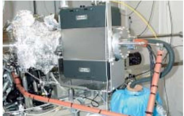
図3 真空槽内壁冷却用液体窒素配管
