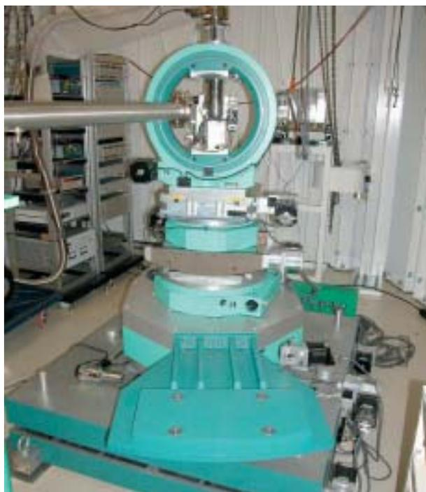
図4 RI棟実験ハッチ3の2軸回折計とHeフロー型冷凍器
