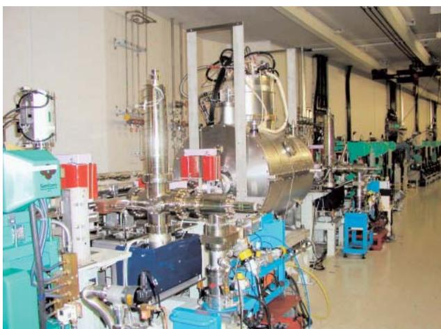
写真6 蓄積リング5セル直線部に設置された超伝導ウイグラー。
