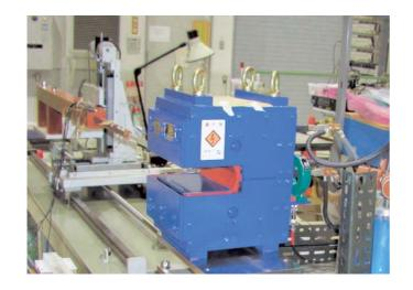
写真8 蓄積リング入射部に導入予定の新しい バンプ磁石の磁場測定の様子。ビーム入射時の 蓄積ビーム振動を抑えるため、渦電流の影響が 小さくなるように設計されている。
