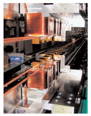
写真10 BL17SU用挿入光源磁石部。中心に垂直磁場発生用の電磁石、サイドに水平磁場発生用の永久磁石が設置されている。垂直磁場は電磁石の電流値、また水平磁場は磁石列の電子ビームの進行方向への駆動(phasingという)により調節する。電磁石の通電系統は2つあり、これにより、周期長を倍の長さにしたり(ヘリカルアンジュレータモード) 磁場に強弱をつけたり(非対称8の字アンジュレータモード)することができる。
