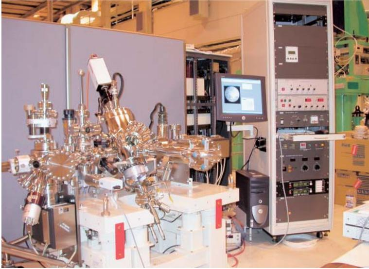
写真11 軟X線光電子顕微鏡
