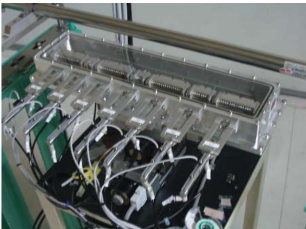
図2 焦点距離遠隔操作調整システム本体、Beレンズをまとめたユニットを圧搾空気動力で出し入れしてレンズ枚数を調整する原理である。
