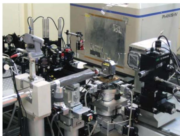
図1 レーザー加熱光学系を備えたX線回折装置(改造後)。レーザー光学系ステージの階下にYLF、YAGレーザーが装備されている。
