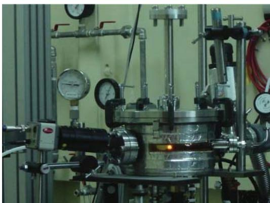
(a) 試料浮遊型コンテナレス電気炉
