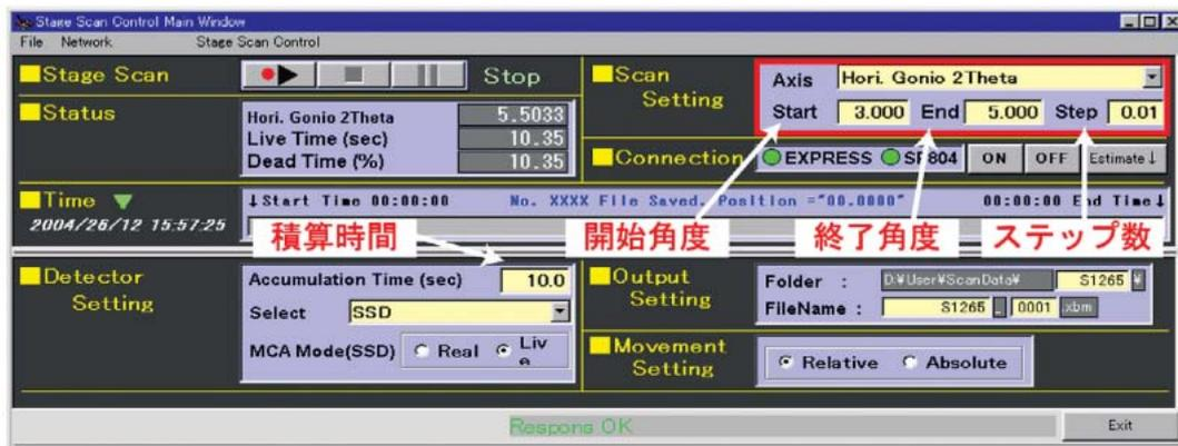
図2 角度分散実験用プログラム
