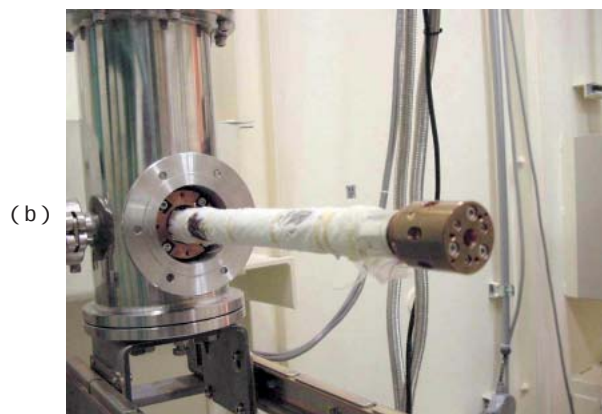
図2 (a)磁気コンプトン散乱スペクトロメータ用に開発されたダイヤモンド・アンビル・セル、(b)スペクトロメータに取り付けられた様子
