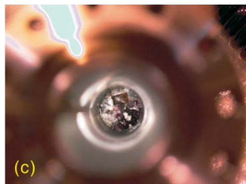
図8 超伝導磁石の試料槽先端Be部。外側の粘性の高い付着物（図(a)矢印）。付着物を取り去った後見つかったピンホール（図(b)矢印）。内側のカプトンや粉末試料などによる汚染（図(c)）。
